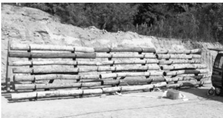
Fig. 6. Vista d'insieme frontale e laterale del campo prove durante l'installazione del primo stendimento del prototipo I. L'elemento strumentato è quello centrale.
