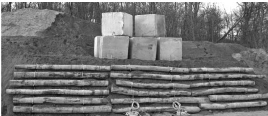
Fig. 11. Vista d'insieme del campo prove con il prototipo 2 dopo l'applicazione del sovraccarico.
