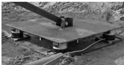
Fig. 13. Posizionamento dei trasduttori di carico sotto la piastra della palificata loricata strumentata (prototipo 2). Load transducers at the anchor plate (prototype 2).
