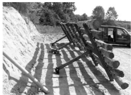
Fig. 6. Vista d'insieme frontale e laterale del campo prove durante l'installazione del primo stendimento del prototipo I. L'elemento strumentato è quello centrale.
